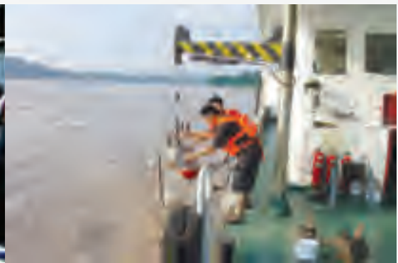
使用调压式采样器采样
