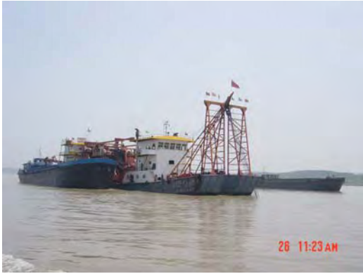
用于建筑砂石料开采的吸砂泵式采砂船
