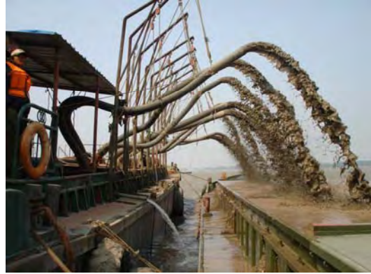
用于吹填造地采砂的吸砂泵式采砂船
